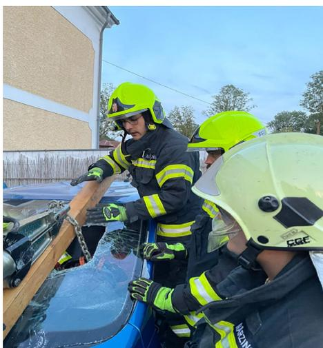
**Hydraulisches Rettungsgerät – Kettensatz**
